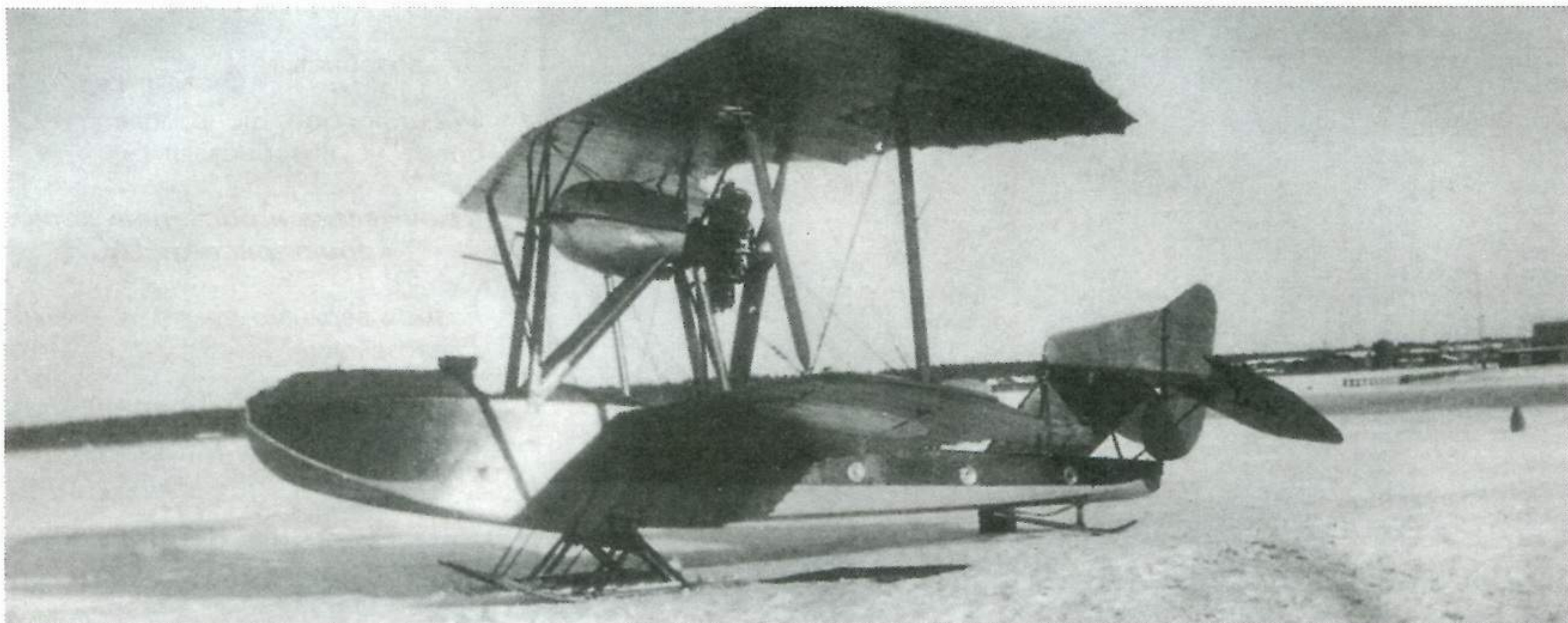
М-11 на лыжном шасси при проведении полетов зимой
