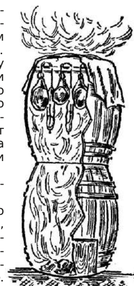
Рис. 14. Устройство коптильни из двух бочек
