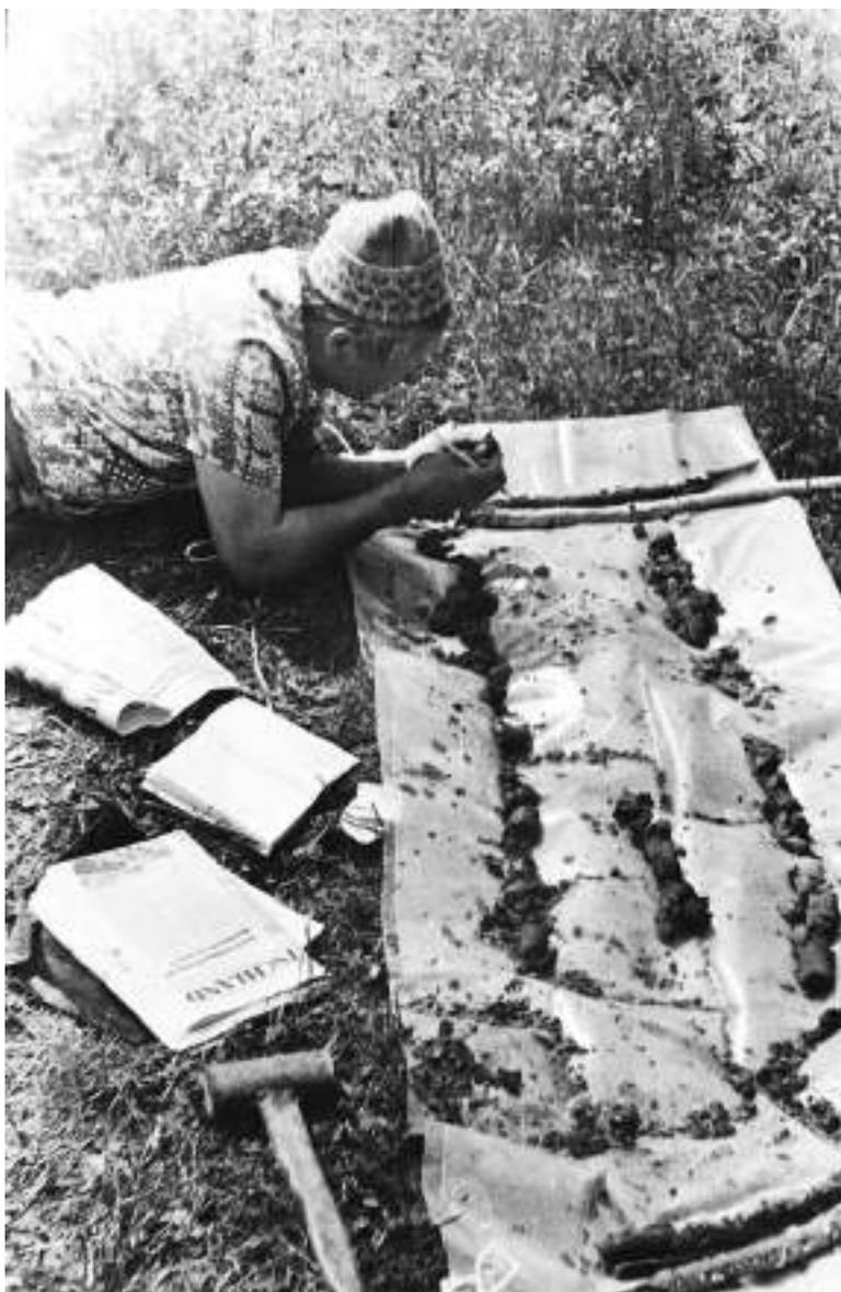
Рис. 46. А. Авдонин производит описание керна материала скважин ручного бурения, 1979 год.
