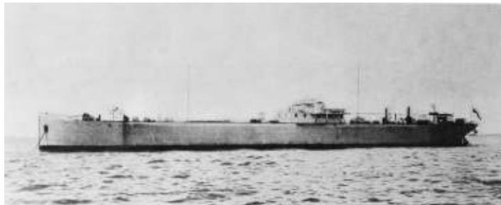
Первым отечественным морским теплоходом (правда, использовавшимся на ограниченной акватории Каспийского моря) стал танкер "Дело", построенный в 1908 г. на Коломенском заводе по заказу предпринимателя Меркульева. Танкер имел дедвейт 4200 т при длине 108,4 м. Он был оборудован двумя главными четырехтактными четырехцилиндровыми реверсивными дизелями постройки Коломенского завода мощностью по 340 кВт.
